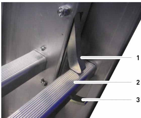
Рисунок 11: Рычаг управления – стопорный рычаг
